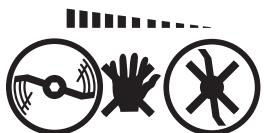
Остриетата ще продължат да се въртят след изключване на машината.
