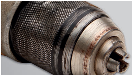
Beschädigtes Bohrfutter - Werkzeug nicht gepflegt
