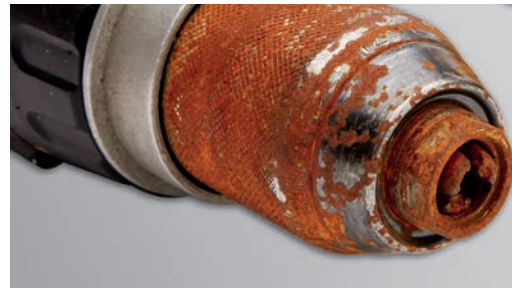
Verrostetes Bohrfutter - Feuchtigkeit etc.
